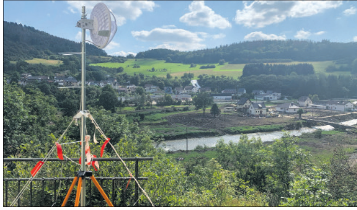
Provisorische Richtfunkantenne im Ahrtal zur Versorgung mit Internet und VoIP-Telefonie. Foto: BS/DRK
